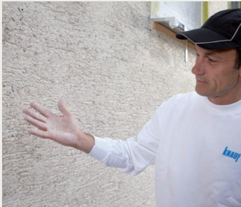
Die Prüfung durch Wischprobe mit der flachen Hand ist erforderlich, um Staub und Schmutz festzustellen. Die Wischprobe ist unbedingt an mehreren Stellen durchzuführen.
