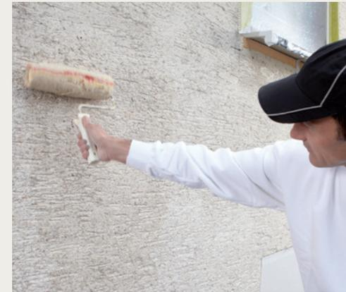
Bei der Benetzungsprobe wird sauberes Wasser mit einer gut angefeuchteten Deckenbürste gleichmäßig aufgetragen. Der Untergrund ist ausreichend saugfähig, wenn nach spätestens 3 - 5 Min. der Farbumschlag von hell auf dunkelgrau stattfindet und das Wasser nicht vom Untergrund abperlt.
